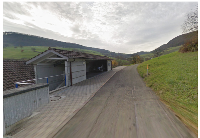
Dank Parkierung entlang der Erschliessungsstrasse kann auf aufwendige Erschliessungsinfrastruktur im Hangbereich verzichtet werden (Häuptli, Thalheim).
